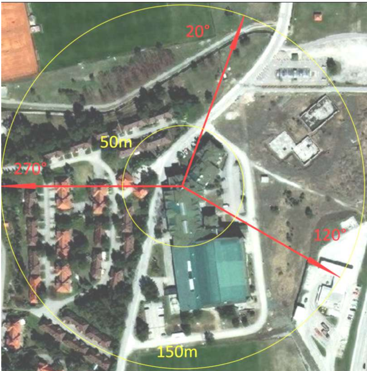
Slika 5.1 Dijagram zračenja radio bazne stanice "Zlatibor (TRK)"- UE180/UEU180/UEL180/UEO180/UEJ180
