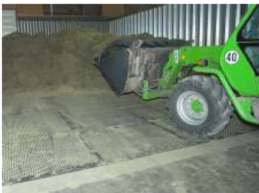
Sl.34. Oprema za sušenje usitnjene drvene biomase, podnom ventilacijom (levo), rotacionom sušarom (desno)
